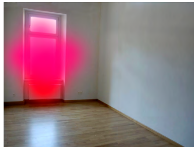
Bewegung warmer Heizungsluft in Richtung kühlerer Luft am Fenster
